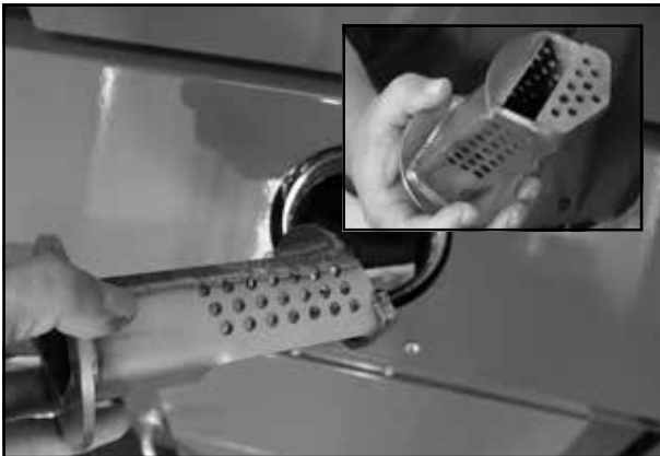
Die Zünd- und Blindkammer herausnehmen
