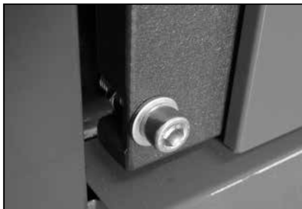
Die Sicherungsschraube der Nachlegetür angezogen
