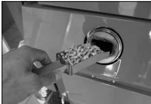
Die Zündkammer mit Pellets zur Entzündung befüllen
